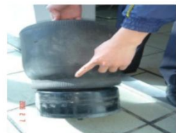
图 26 气囊漏气破损
