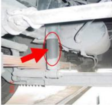
图 30 减震器假性漏油
