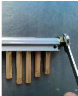
拆下加油口接头
