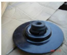
图 25 气囊上盖缓冲块损坏
