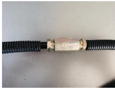
使用直通内螺纹接头连接管路
