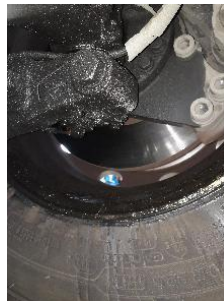
使用直通内螺纹接头连接管路
