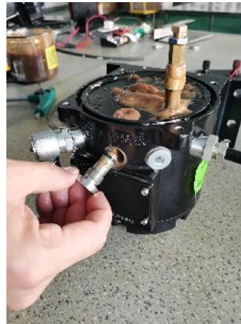
拆卸卸荷阀堵头
