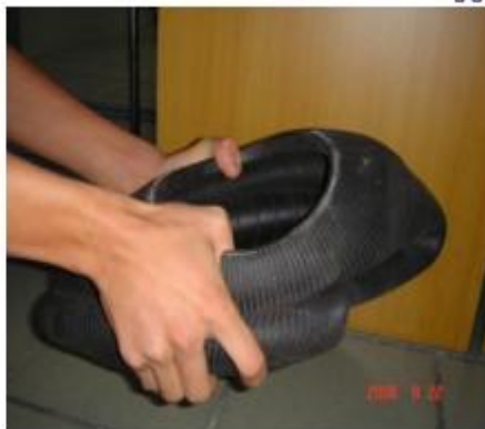
图 34 双手用力将新气囊皮抽住
