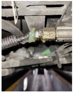
①接头松动、压偏、卡套装反、管切口不平齐 ②连结体开裂
