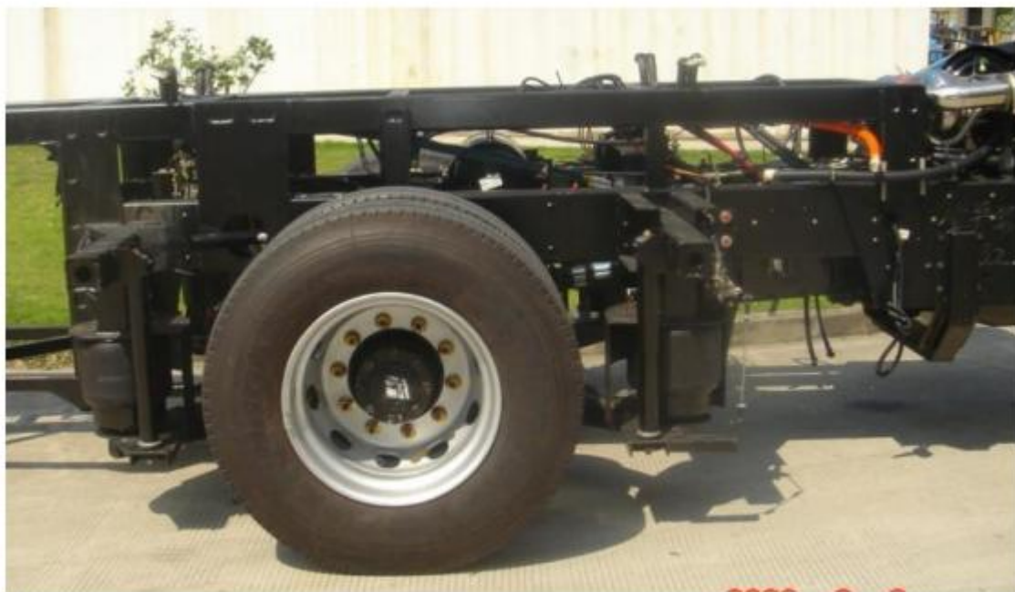
图 14 后悬气囊、减震器安装位置
